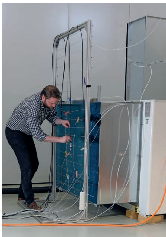
Bevor eine Wärmepumpe das Gütesiegel erhält, wird sie in einem Prüfzentrum intensiv ausgemessen. In der Schweiz ist das Prüfzentrum in der NTB Buchs.
