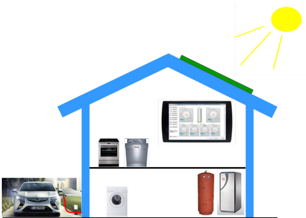
Abbildung 1: Gebäude mit Eigenverbrauchsmanager und betrachtete Komponenten wie Photovoltaikanlage, Wärmepumpe, Brauchwarmwassererwärmer, Elektromobil (Plug-In-Hybrid) und Haushaltgeräte.
