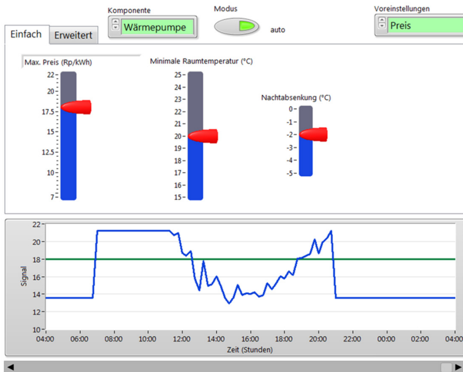
Abbildung 9: Kosten-Optimierung für die Wärmepumpe. Vorgabewerte sind die Preisgrenze in Rp/kWh (Schieberegler links) sowie die minimale Raumtemperatur in °C (Schieberegler Mitte/rechts). Im Plot unten ist der Verlauf des variablen Strompreises (blau) sowie die vorgegebene Preisgrenze (grün) dargestellt. Beim Unterschreiten der Preisgrenze wird die Wärmepumpe eingeschaltet.
