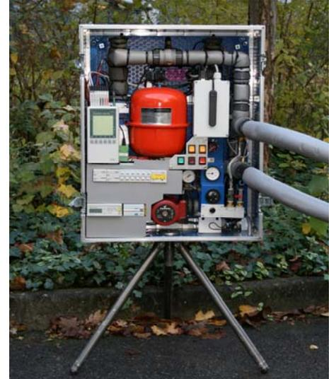
En plus du data-logger qui effectue l'acquisition des différents paramètres, le système de télétransmission permet de suivre en temps réel sur Internet l'évolution du test.
