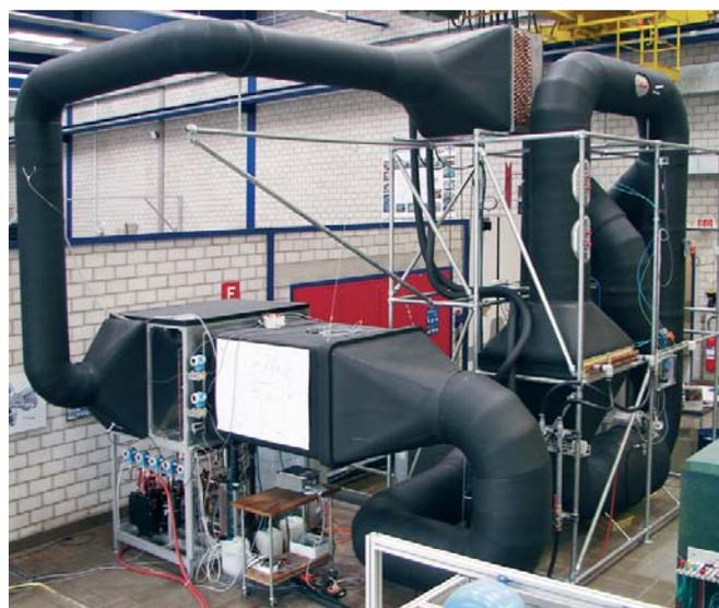
Prototype de pompe à chaleur avec un Scroll-Inverter dans le laboratoire de contrôle de l'école supérieure de Lucerne.
