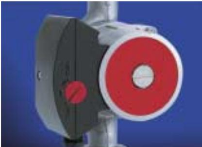
Enclenchez le circulateur au début de la période de chauffage et contrôlez que la pompe fonctionne sur le niveau de réglage le plus bas. Si la pompe est réglée sur un niveau plus élevé, baissez-la et vérifiez que les radiateurs chauffent. Si les radiateurs ne chauffent pas, montez d'un cran le réglage de la pompe.
