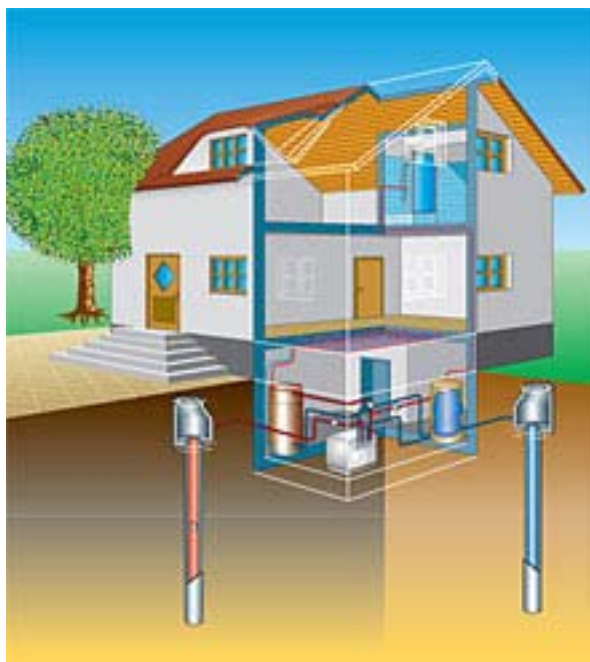
Fig. 6 > Schéma de principe d'une pompe à chaleur eau-eau
