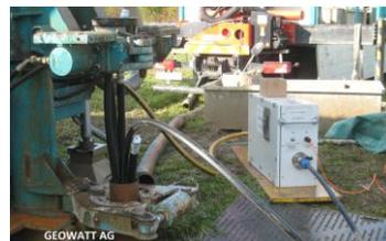
HMG-S et HMG-K. Impression du protocole de mesure. Appareil de mesure HMG-K en service.
