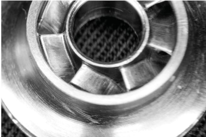
*Bild 3: Fertigungsmuster eines Laufrads, im Zustand nach der Herstellung.*
