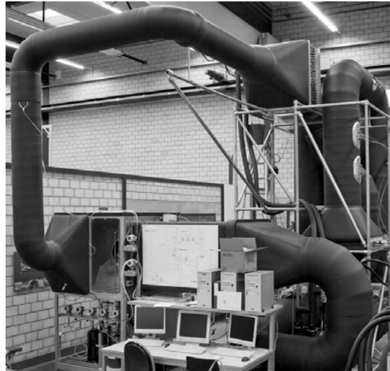
Bild 10: Luftaufbereitungsanlage und L/W-WP-Prototyp
