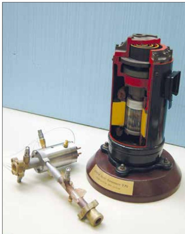
Illustration 3: comparaison entre un compresseur radial à paliers à gaz et un compresseur Scroll équivalent.
