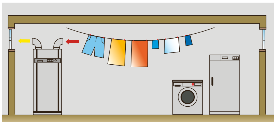
Abbildung 5.14: Aufstellung von Wärmepumpen-Wassererwärmer zur Raumentfeuchtung.
