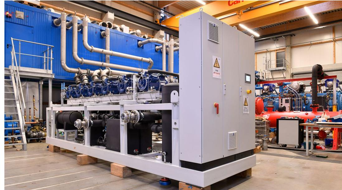
**CO<sub>2</sub>** Wärmepumpe thermeco2 Hochtemperatur-
