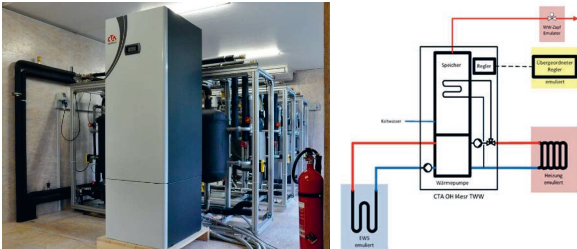
Abbildung 8: Laboraufbau mit WP, Emulatoren; rechts das HIL-Schema
