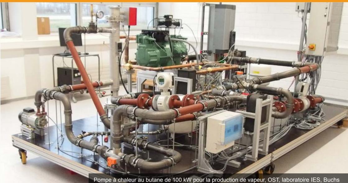
Pompe à chaleur au butane de 100 kW pour la production de vapeur, OST, laboratoire IES, Buchs
